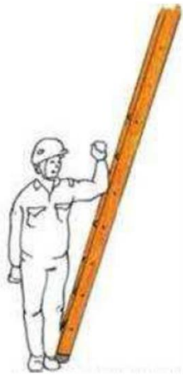
METODO APPROSSIMATO PER VERIFICA CORRETTA INCLINAZIONE DELLA SCALA
